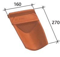
Closoir de faîtiage «casson» Omega 10 (8 unités par ml de faîtiage) Réf. 104.140
