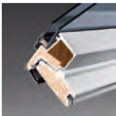
GPU/GHU – rdzeń drewniany pokryty ciśnieniowo poliuretanem, w kolorze białym.
